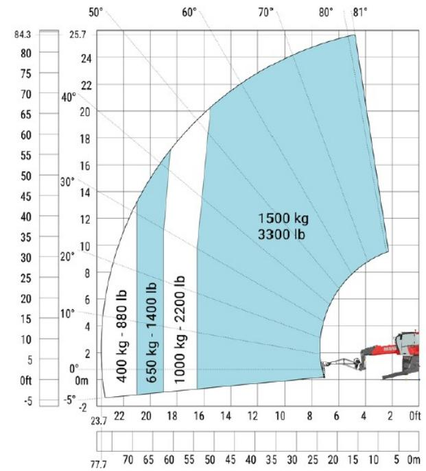
Maschine auf abgesenkten Stabilisatoren mit ausfahrbarem Windenarm (Metrisch) Maschine auf abgesenkten Stabilisatoren mit Haken 6000 kg (Metrisch)
